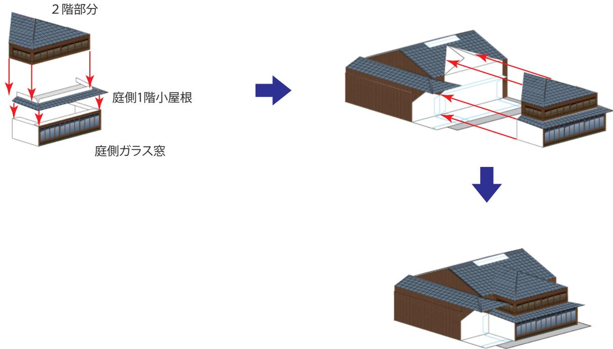
4 [庭側屋根]、[庭側壁]、[屋根小]を組み立て、3に付けます。
